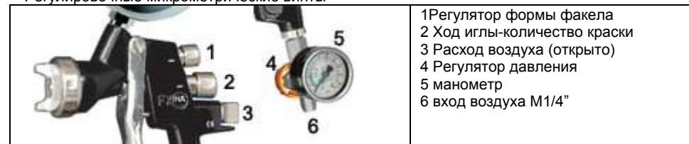
Регулировочные микрометрические винты
